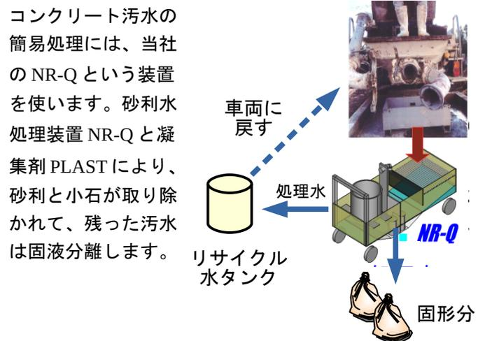
汚水の汚れは凝集されて汚泥になります。処理水は放流基準までpH調整後、放流または再利用できます。固形分と汚泥はコンクリート二次製品として再利用できます。
